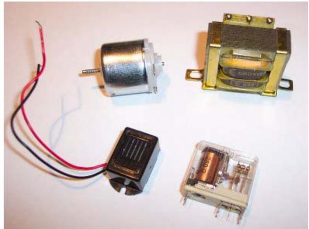
Motor, zumbador, transformador y relé
