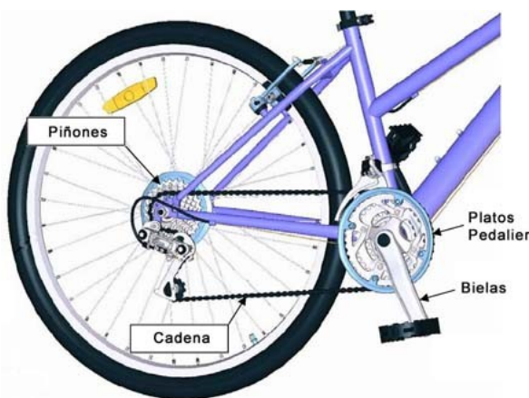
Fig 4: El mecanismo de la bicicleta (cadena) permite comunicar la fuerza motriz proporcionada por el ciclista desde el plato de los pedales al plato de la rueda trasera donde están los piñones.
