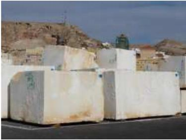
Se denomina **mármol** a un tipo de roca metamórfica compacta formada a partir de rocas calizas que, sometidas a elevadas temperaturas y presiones, alcanzan un alto grado de cristalización. El
