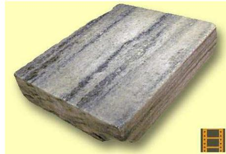
componente básico del mármol es el carbonato cálcico.
