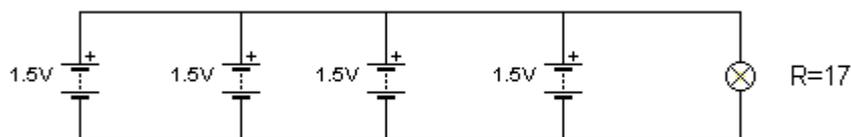
Pilas en paralelo, la bombilla recibe un voltaje igual al de una de las pilas.
