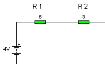
4. (1 p) Calcula en el siguiente circuito la intensidad que produce la pila ( $I_{PILA}$ ) y el voltaje que recibe la Resistencia  $R_2$  ( $V_2$ ).
