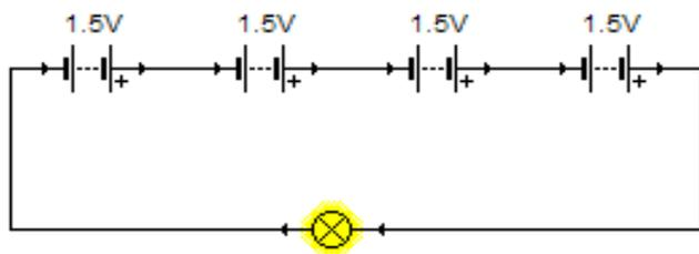
Pilas en serie, la bombilla recibe un voltaje igual a la suma de los voltajes de las pilas
