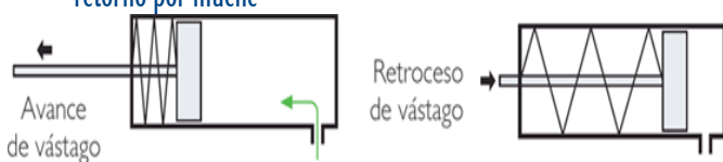
Fig 7: Principio de funcionamiento de un cilindro S/E con retorno por muelle
