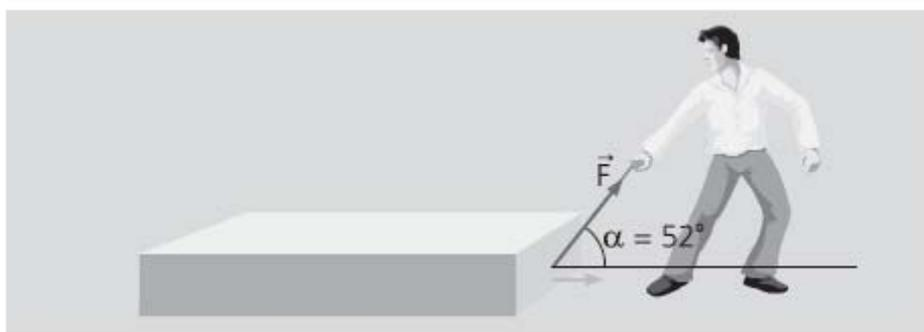
Para que la caja se mueva, la componente de la fuerza en la dirección horizontal debe tener un valor de 150 N. Teniendo en cuenta que esta componente se relaciona con la fuerza aplicada a través de la cuerda mediante el coseno del ángulo que forma la cuerda con la horizontal, podemos calcular el valor de la fuerza con que es necesario tirar de la caja, despejando de la expresión:
