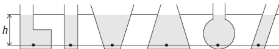
**40. Para abastecer de agua a una vivienda cuya altura máxima es de 7 m se va a instalar un depósito. ¿Cómo debemos ubicarlo, para que no se precisen sistemas de bombeo? Indica en qué principio te basas.**
